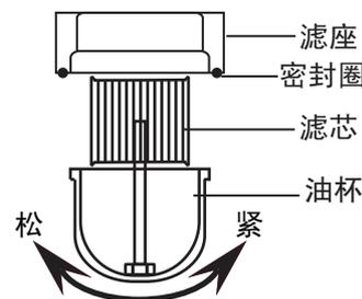
**注意：**过滤器安装时，请一定保证密封圈与油杯的配合，滤芯有小孔的一面请朝上。
